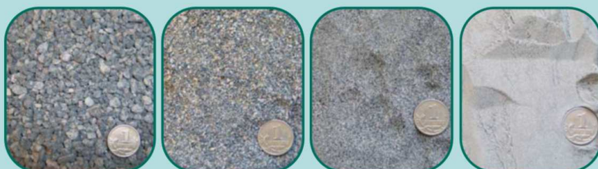
Гранитный отсев, разделенный на воздушном классификаторе.
