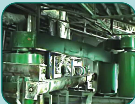
КОСТРИЖЕВСКИЙ КОМБИНАТ СТРОЙМАТЕРИАЛОВ, 2005 г. ДИСМЕМБРАТОР и ЦЕНТРОБЕЖНЫЙ КЛАССИФИКАТОР 12т/ч, гипс, (комплекс на базе дисмембратора)
